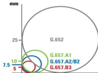
Los Jumpers G657A1 se utilizan en instalaciones de Redes de acceso avanzado, es una fibra de baja sensibilidad, proporciona un alto ancho de banda y una excelente propiedad de transmisión.
