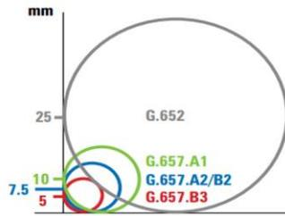
Los Jumpers G657A2 se utilizan en instalaciones de Redes de acceso avanzado, donde requieren una mayor resistencia a la curvatura y son totalmente compatibles con cualquier otra fibra del modelo G652
